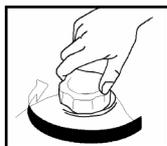
Retire la tapa del tanque de combustible girándola en sentido antihorario.
